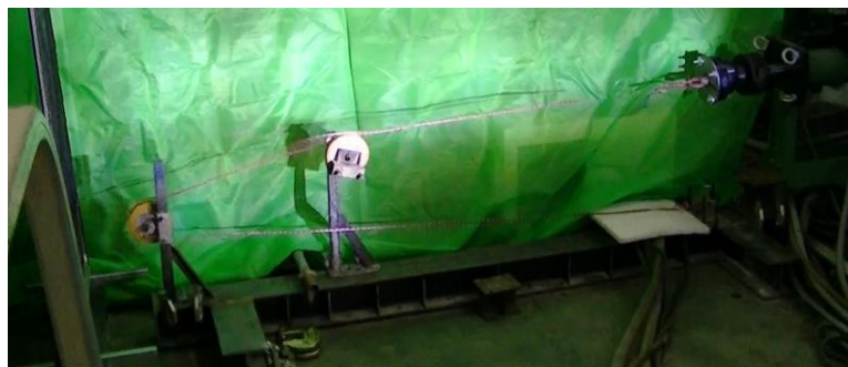
写真 2-2 ダイヤモンドワイヤーの激突試験 実験場所：独立行政法人労働安全衛生総合研究所
